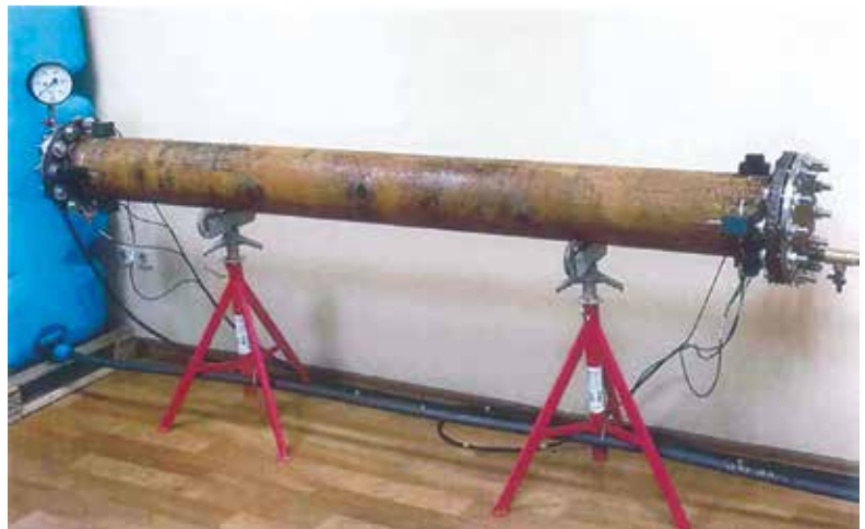
Hình 3. Mẫu thử kiểm tra bằng PDT.
