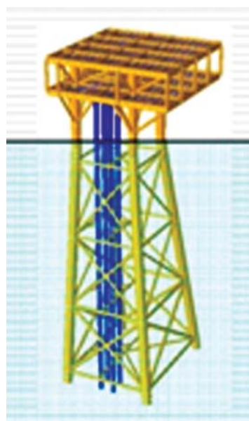
Hình 7. Mô hình chân đế sử dụng cọc để cố định
